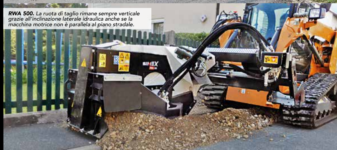
RW 150 su pala. Microtrincea a profondità 150 mm e larghezza 25 mm.
